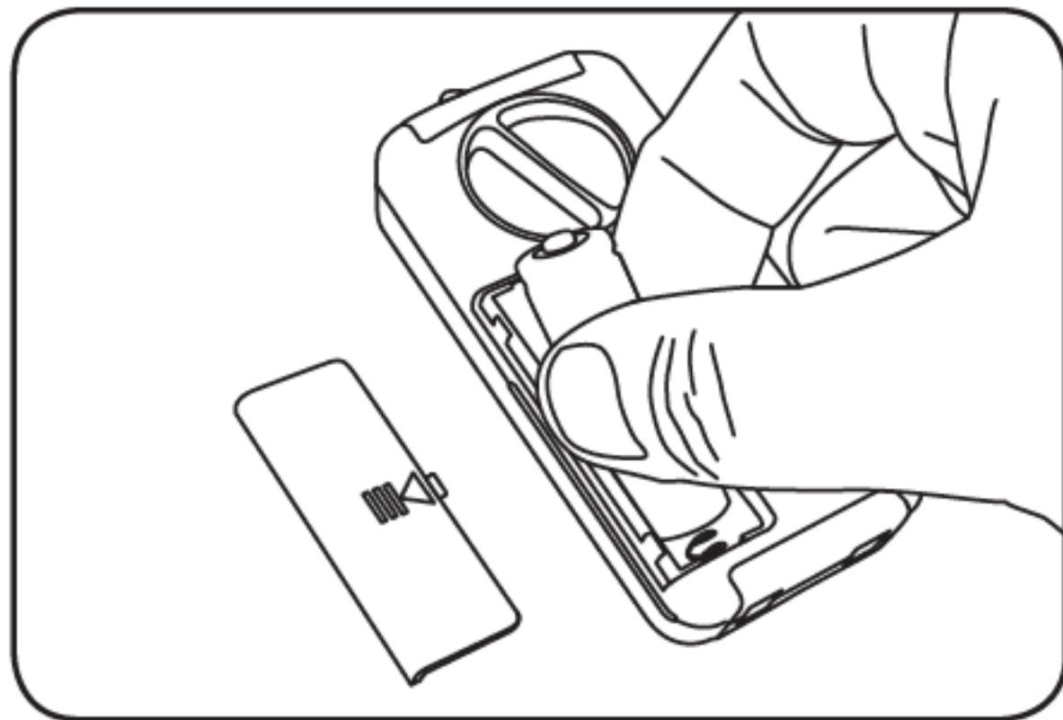
Quitar la tapa de pilas de cada luz colgante deslizándola en la dirección de la flecha. Colocar una pila AA de níquel-hidruro metálico en cada luz, con el lado negativo en contacto con el resorte. Volver a colocar la tapa.
